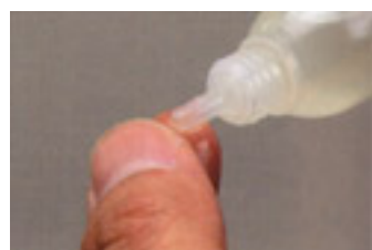
30mlのコート剤と綿棒で1セット。薄塗りを心掛ければ、クランクケースカバー周りのパフまたはウェットブラスト済みパーツ全てに処理しても余るくらい。欲張って厚塗ると、後になってトラブルを招くから、大量に使わない方が良い結果につながる。
