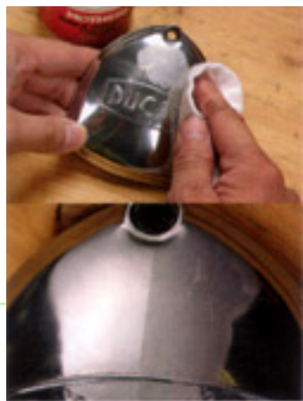
2日間常温乾燥させた後にマスキングテープを剥がし、マザーズのマグボリッシュでパーツ全体を研磨する。研磨後の表面を見ると、コーティングを行った右半分は被膜が機能して研磨されていないことから、物理的な研磨に対する表面保護性能は高いと言える。つまりあらかじめ研磨した地肌塗布しておけば、透明な被膜によって保護されるというわけだ。
