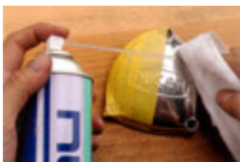
パフ研磨済みのアルミパーツ表面の半分をマスキングテープでカバーして、パーツクリーナーで脱脂する。サンドペーパーによる足付けは不要だが、油分は取り除く必要がある。
