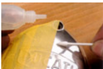
綿棒に少量のG1コート垂らし、パーツ表面にこすりつける。塗り加減は、パーツ表面がしっとり濡れる程度でいい。不適のペイントのように膜を作る必要はない。
